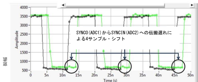
図6b - リファレンスクロック率 T_{CLK} でのSYNCトレーニング（粗調整）
